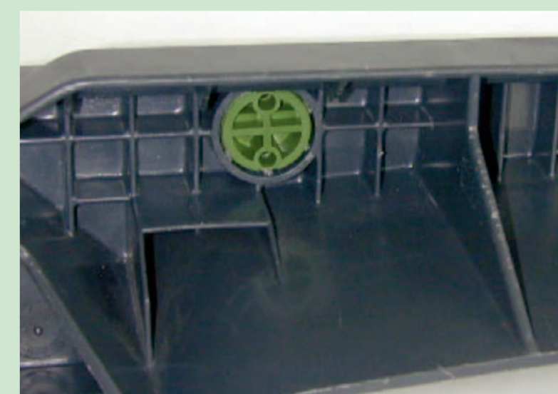
Anbringung des Transponders in Chipnest in Einhängeleite des Müllbehälters (Bildquelle: Moba AG)
